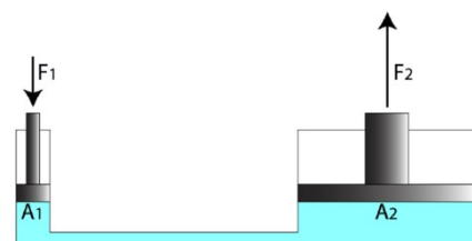
Primjer hidrauličke dizalice (Manjom silom F_1 savladavamo
